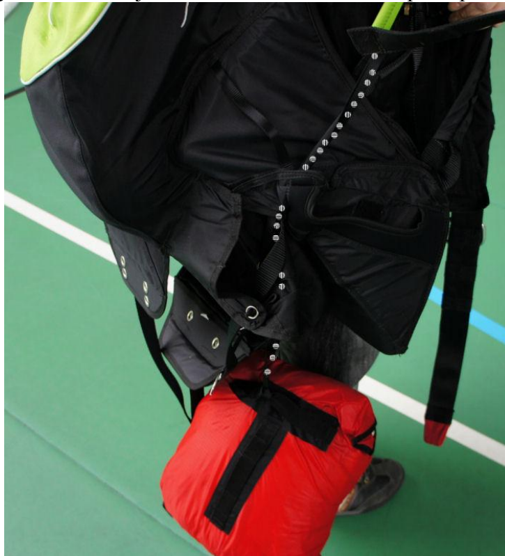
En pointillé le trajet de la sangle qui relie la poignée au pod !
